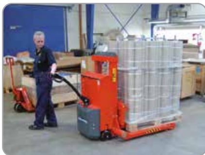
Optimale veiligheid dankzij het transparant, schokbestendig veiligheidsscherm en de verlaagde rijsnelheid.
